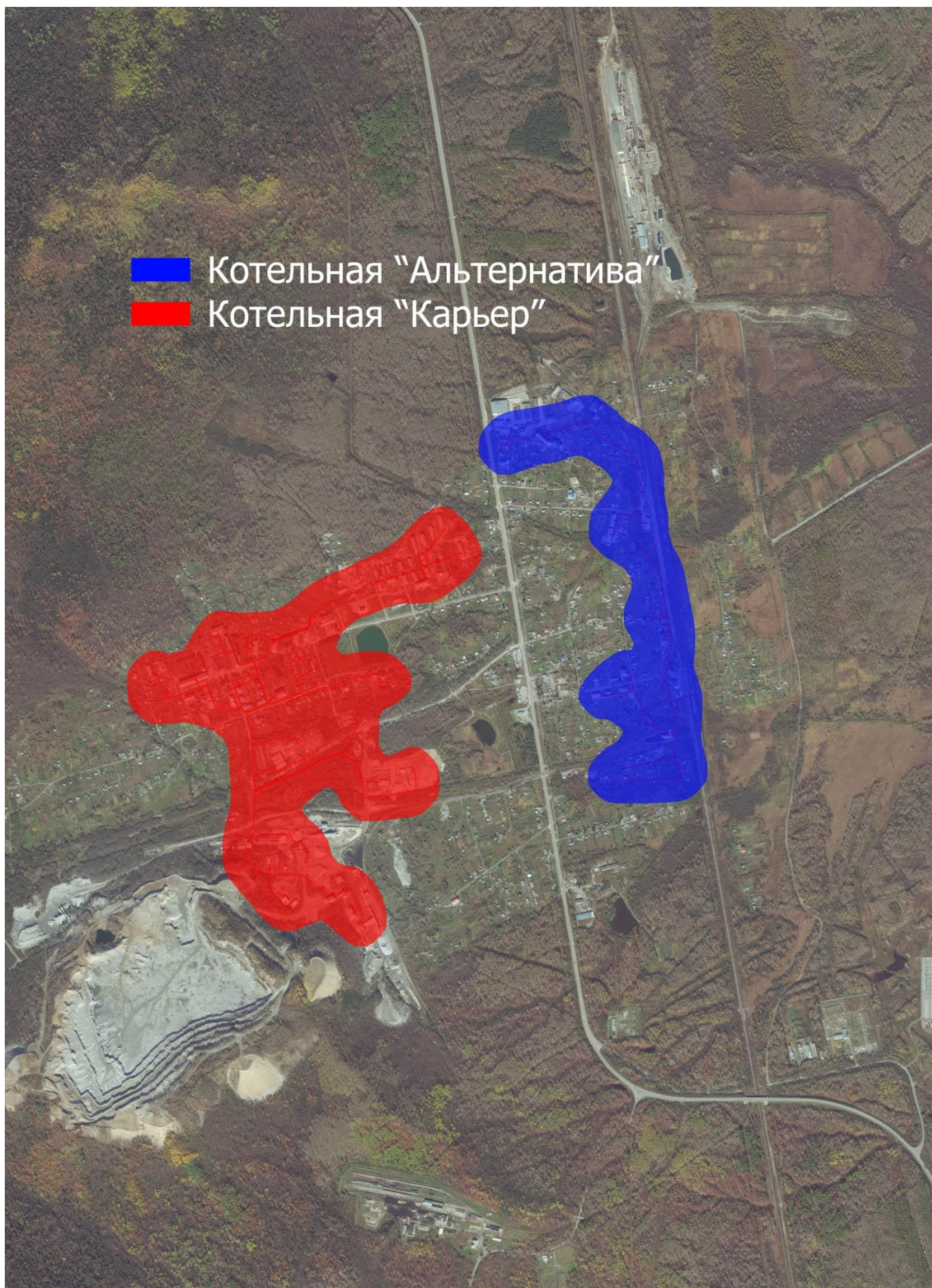
Рис. 2.1 – Зона действия системы теплоснабжения пгт. Корфовский.
